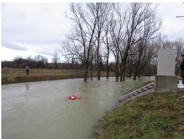
Slika 34: Meritev pretoka Lijaka v Volčji Dragi (levo) in Vipave v Zaloščah (desno) 3. februarja 2019 (foto: arhiv ARSO)
