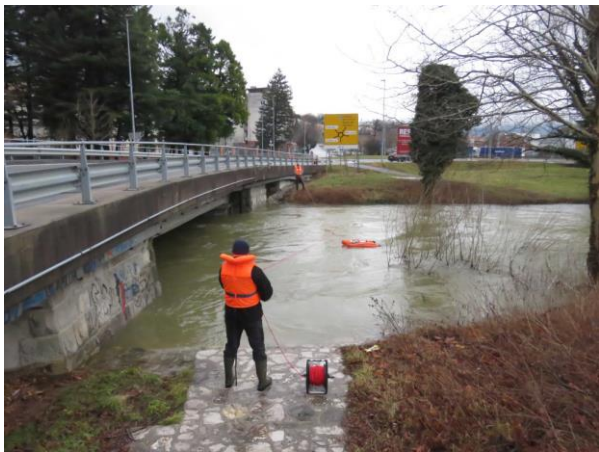
Slika 33: Meritev pretoka Vipave v Vipavi (levo) in v Dolenju (desno) 3. februarja 2019 (foto: arhiv ARSO)
