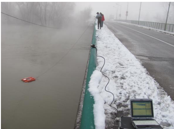
Slika 8: Meritev pretoka na VP Metlika - Kolpa (foto: P. Gajser)
