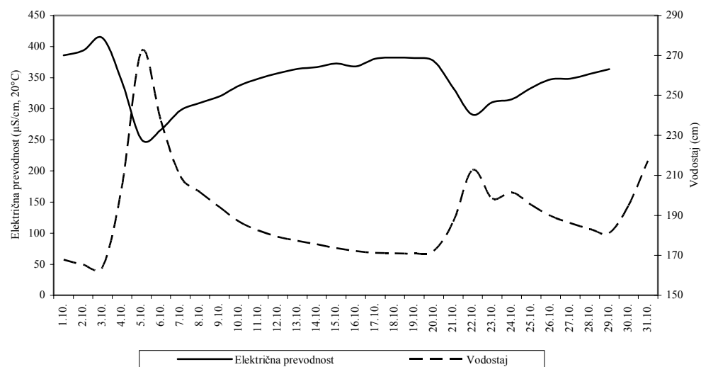
Slika 5.6. Povprečne dnevne vrednosti električne prevodnosti in vodostaja na postaji Savinja Medlog v oktobru 2003 Figure 5.6. Average daily values of conductivity and level at station Savinja Medlog in October 2003
