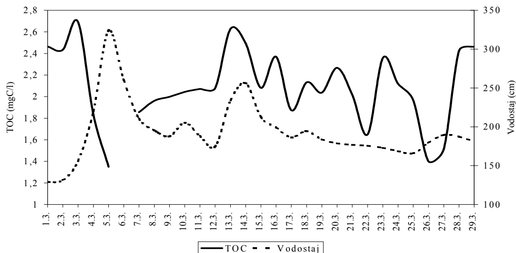
Slika 5.4. Povprečne dnevne vrednosti TOC in vodostaja na postaji Sava Medno v marcu 2001 Figure 5.4. Average daily values of TOC and level at station Sava Medno in March 2001
