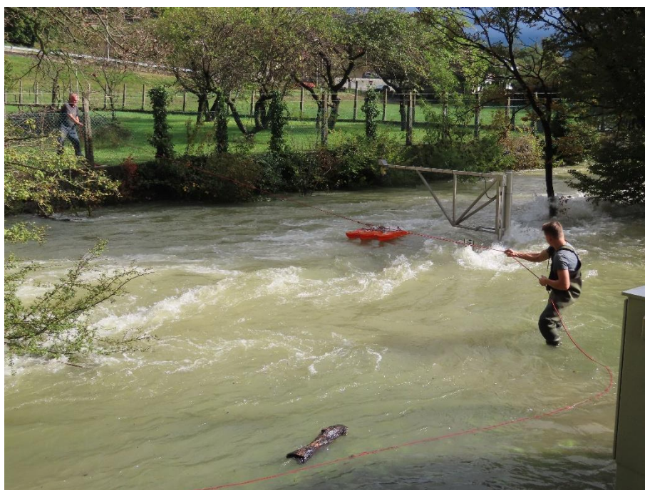
Slika 1. Izvajanje hidrometričnih meritev izvira Hublja v času visokih voda 27. oktobra 2023 (Foto: Arhiv ARSO) Figure 1. Performance of hydrometrical measurements of Hubelj spring at high water conditions on 27 th of October 2023 (Photo: ARSO archive)
